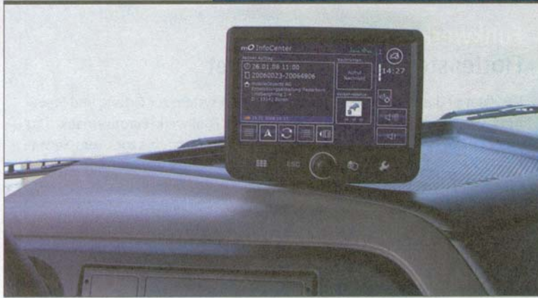
Das Grundgerät von Teledrive passt in einen Radio-DIN-Schacht und hat ein 7-Zoll-Display.
