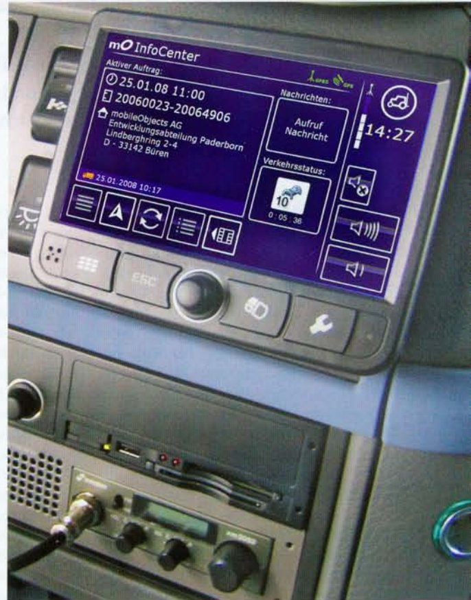
Das TeleDrive 3116 von IAV für die von MobileObjects angebotene Lösung besteht aus einem festeingebauten Bordrechner mit CAN-Bus-Verbindung sowie der 18 Zentimeter durchmessenden Touchscreen-Steuereinheit – ideal für Lkw.
